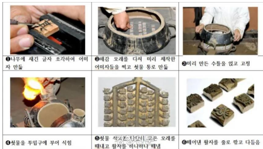
fig. 28 – Esquema que ilustra o processo de confecção de tipos móveis coreanos pela técnica da areia com fundição de ferro 36
