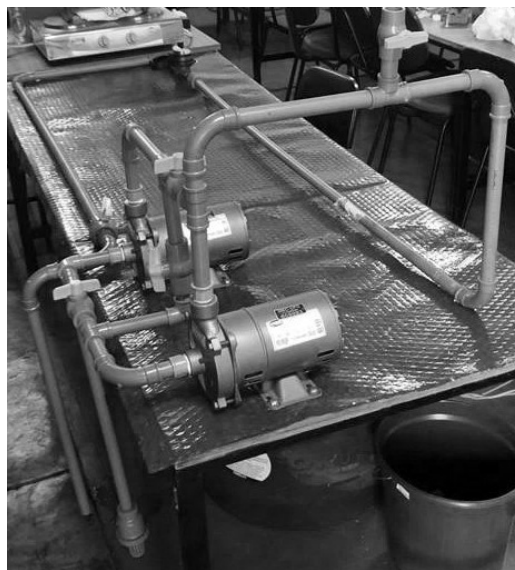
Figura 1.1.5 - Bancada hidráulica para a determinação das curvas de perdas de carga para válvulas de pé projetada por Faria (2015)
