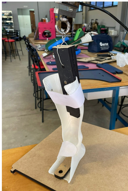
Figura 11 - Estrutura utilizada no teste de força de aderências entre as camadas.
