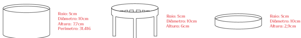
Figura 32 - Desenho técnico da saboneteira/vaso - Medidas das peças
