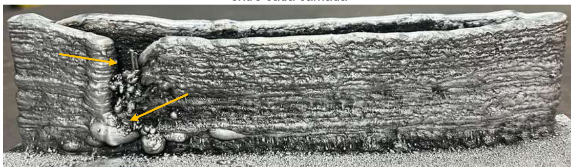
Figura 4.23 – Vista lateral 2 do aerofólio com 100 camadas com tempo de parada de 30 segundos entre cada camada
