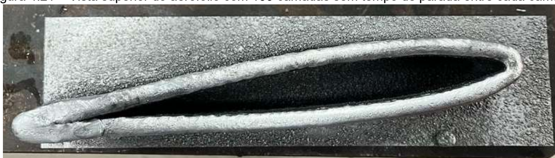
Figura 4.21 – Vista superior do aerofólio com 100 camadas sem tempo de parada entre cada camada
