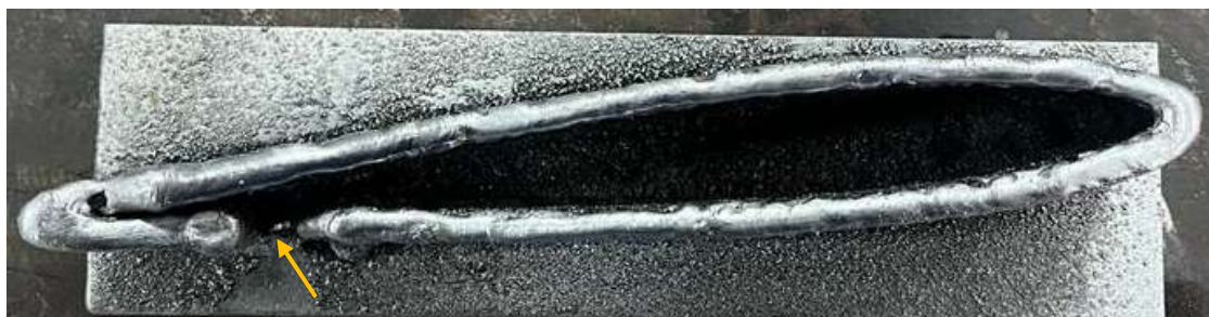
Figura 4.24 – Vista superior do aerofólio com 100 camadas com tempo de parada de 30 segundos entre cada camada
