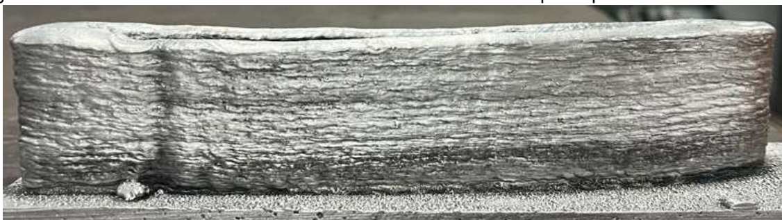
Figura 4.20 – Vista lateral 2 do aerofólio com 100 camadas sem tempo de parada entre cada camada
