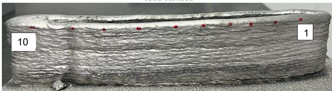
Figura 4.25 – Distribuição dos pontos no aerofólio com 100 camadas sem tempo de parada entre cada camada
