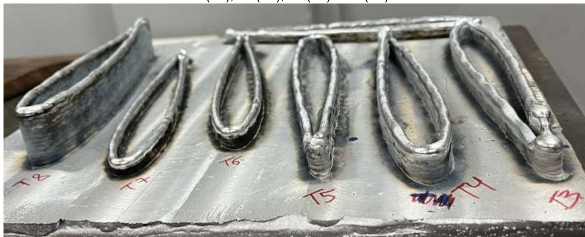
Figura 4.17 – Aspecto visual superior e lateral dos aerofólios dos testes 19 (T3), 20 (T4), 21 (T5), 22 (T6), 23 (T7), 24 (T8) e 25 (T9)
