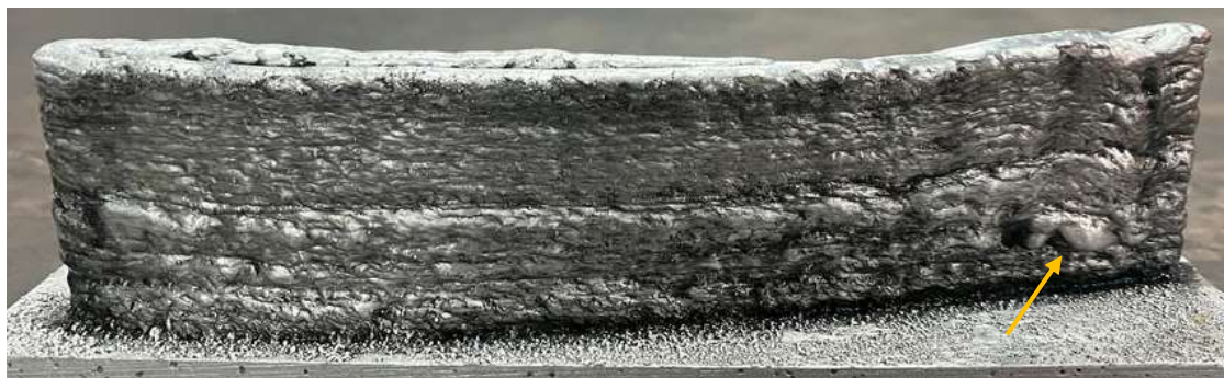
Figura 4.22 – Vista lateral 1 do aerofólio com 100 camadas com tempo de parada de 30 segundos entre cada camada
