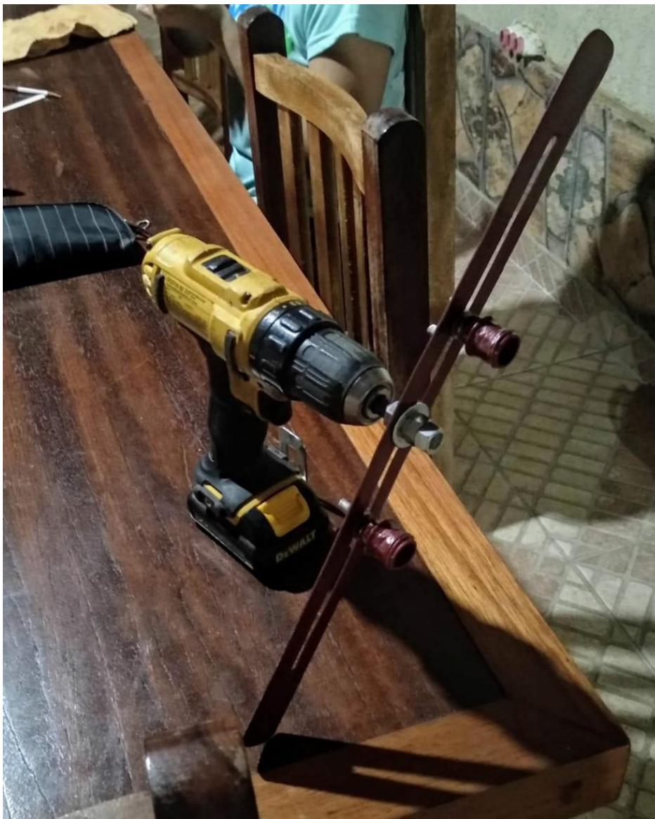
Figura 20 - Bobinadeira feita manualmente.
