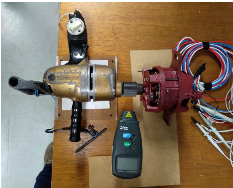
Figura 26 - Esquema de acionamento do micro gerador
