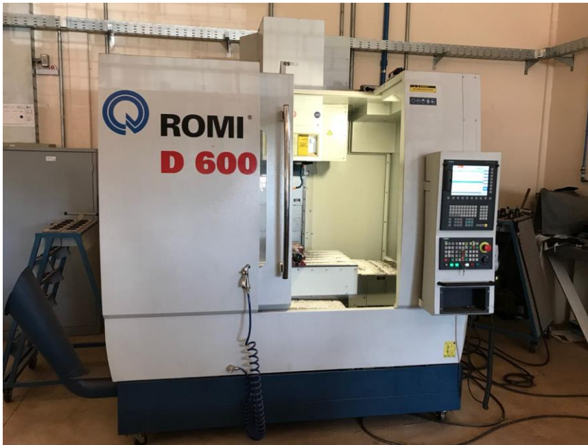
Figura 39 – Fresadora CNC ROMI D600 utilizada nos testes das ferramentas
