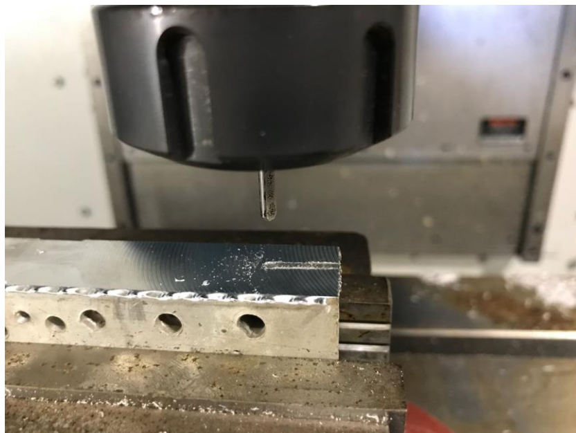
Figura 40 – Canal realizado pelo fresamento com a amostra de metal duro e profundidade de corte de 0,100 mm
