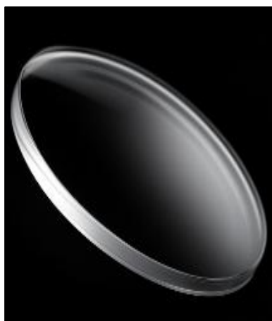
Figura 6 - Lente usinada com ferramenta diamantada em bom estado
