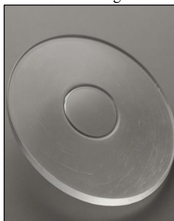
Figura 7 - Lente usinada com ferramenta desgastada
