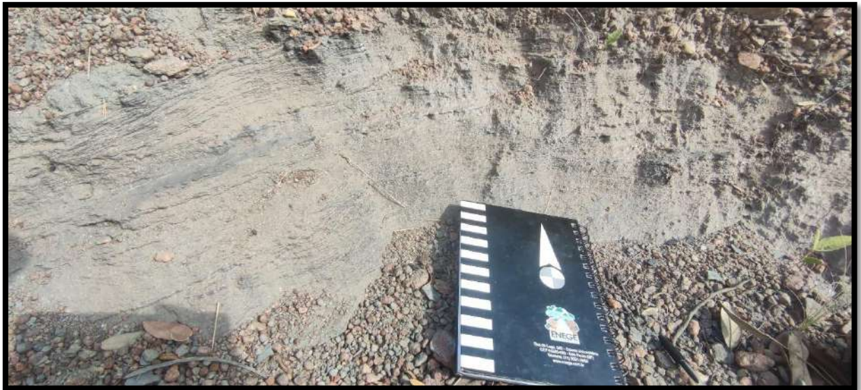
Figura 5-6: Afloramento do xisto carbonático no ponto 95, observado em encosta de estrada vicinal.
