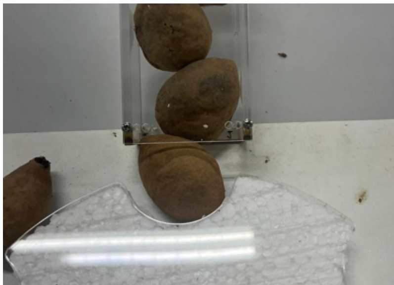
Figura 12 – Detalhe do dosador de engrenagem obstruindo a saída e agravando o travamento do fluxo.
