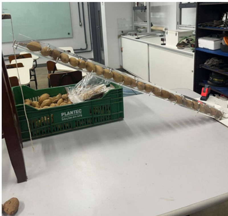
Figura 10 – Condição inicial do ensaio de alimentação em lote, com a calha carregada com frutos de baru.
