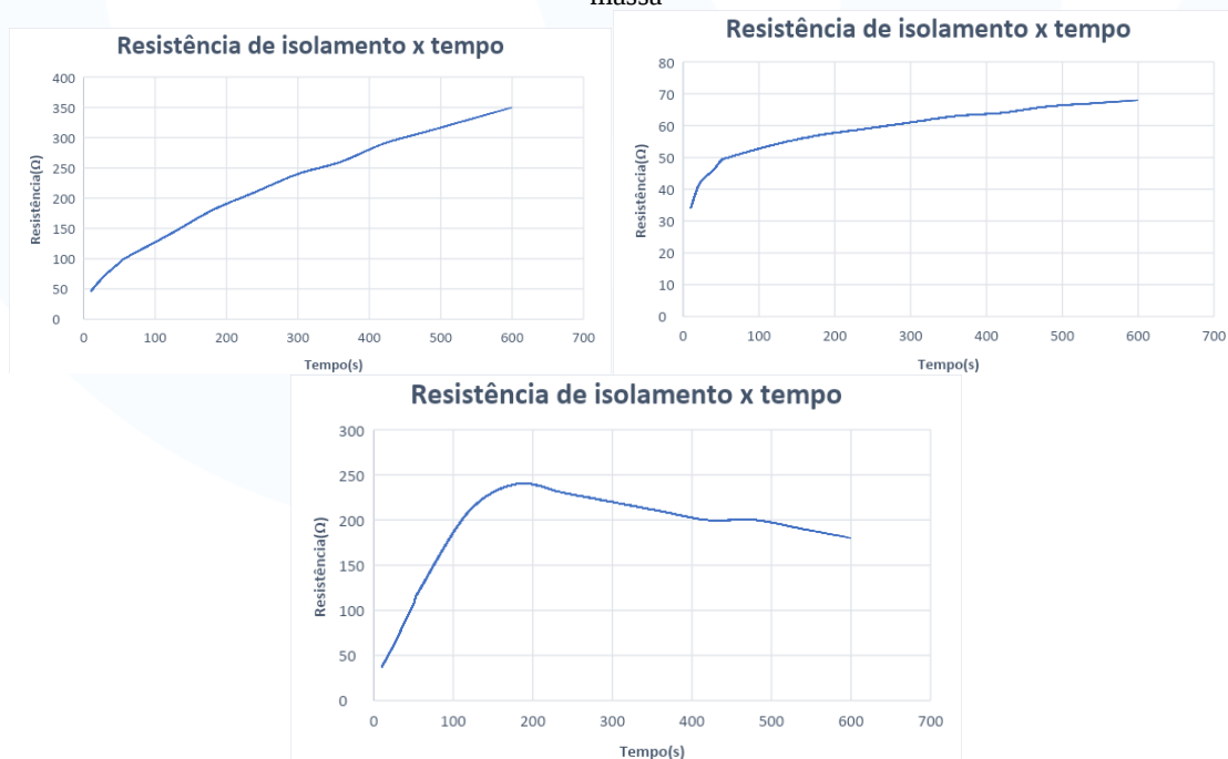
Figura 5 – a) Ensaio da RI dos enrolamentos de alta com relação à baixa b) Ensaio da RI dos enrolamentos de alta com relação à massa c) Ensaio da RI dos enrolamentos de baixa com relação à massa
