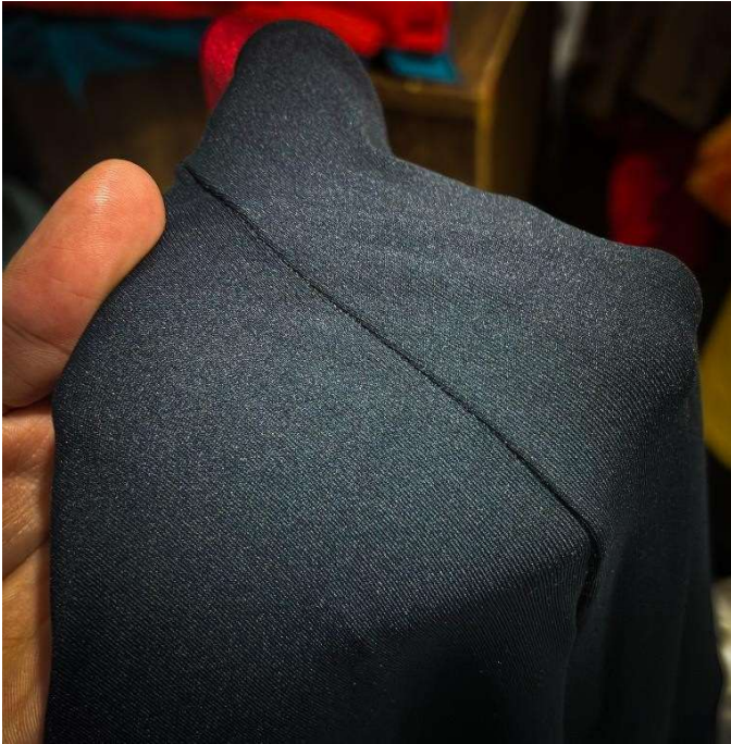
Figura 18 – Teste de costura ponto cadeia em malha 100% polimida.
