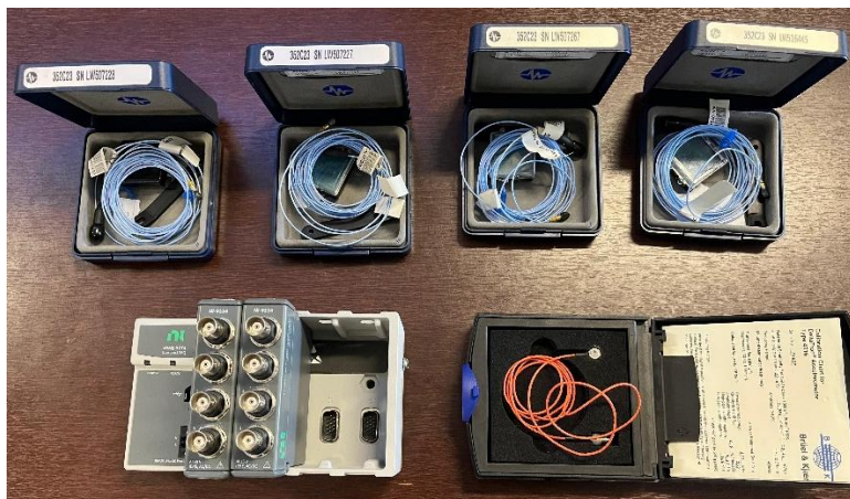
Figura 12: Instrumentos de aquisição de sinais vibracionais
