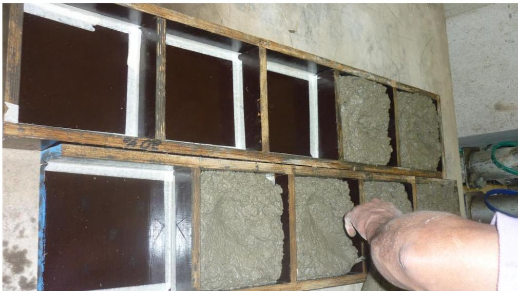
Figura 3.2 - Corpos-de-prova de 20 e 60 MPa no estado endurecido.
