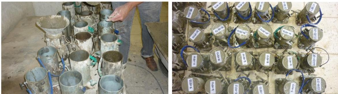
A Tabela 3.2 a seguir, ilustra como foi o processo de rompimento dos corpos-de-prova sem cura, com cura aos 7 dias e com cura as 14 dias. No 1º dia foram rompidos 3 corpos-de-prova de 20 MPa, 3 de 40 MPa e 3 de 60 MPa sem cura. No 3º dia foram rompidos três corpos-de-prova de 20 MPa, 3 de 40 MPa e 3 de 60 MPa, sem cura, 3 corpos-de prova de 20 MPa, 3 de 40 MPa e 3 de 60 MPa com cura submersa de 7 dias, e assim sucessivamente até
