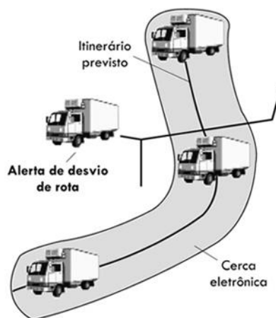
Figura 13 - Monitoramento por cerca-eletrônica
