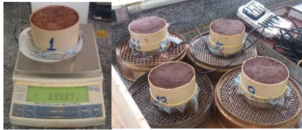
Figura 1. Monitoramento do conteúdo de água do solo pelo método gravimétrico (A), do FDR (EC5) durante o período experimental.
