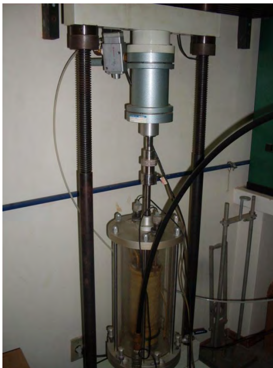
Figura 4.10 - Equipamento triaxial de cargas repetidas.
