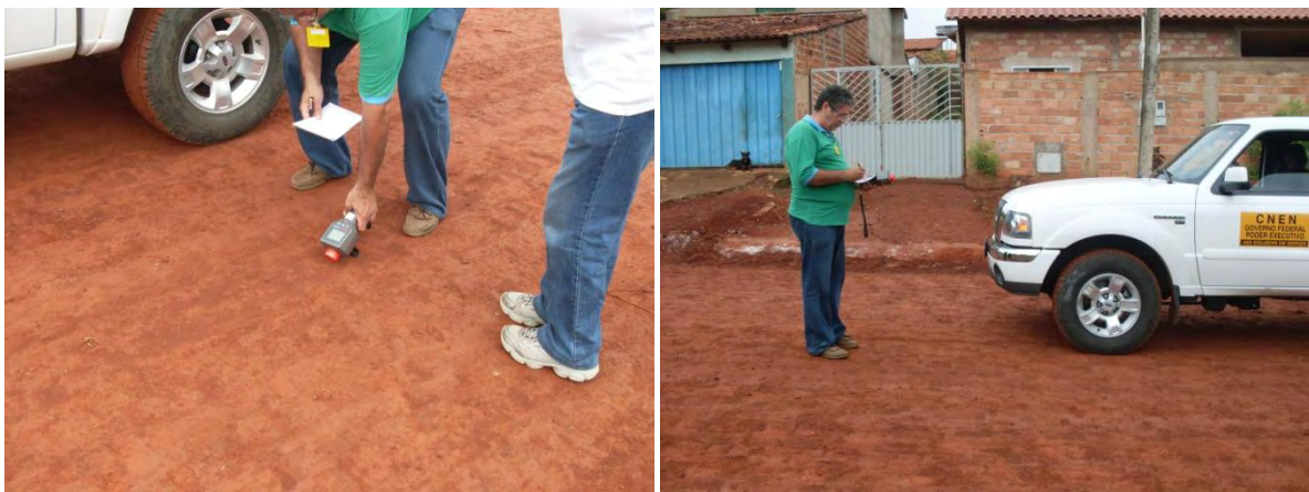
Figura 4.25 - Medições radiométricas nos subtrechos constituídos de fosfogesso
