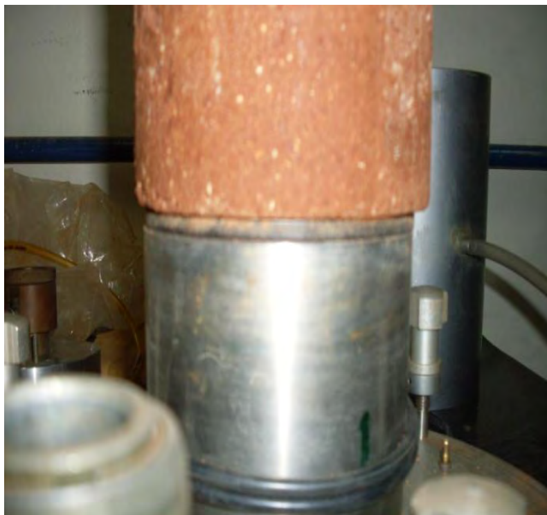
Figura 5.21. Variação volumétrica de um corpo de prova de solo+fosfogesso+cal por expansão.
