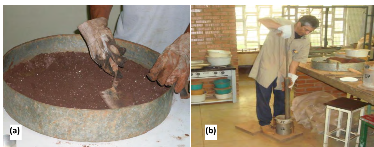
Figura 4.7 – Compactação: (a) Homogeneização das misturas; (b) Compactação no cilindro Proctor.
