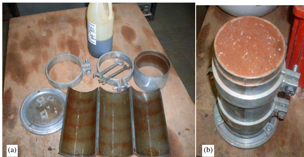
Figura 4.11 – Moldagem do corpo de prova: (a) Cilindro tripartido u; (b) Corpo de prova compactado
