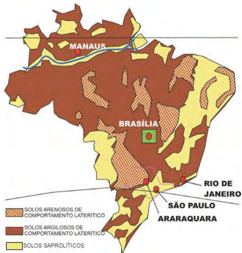
Figura 3.2. Ocorrência dos solos de comportamento laterítico no território brasileiro (modificado de VILLIBOR et al. , 2009)
