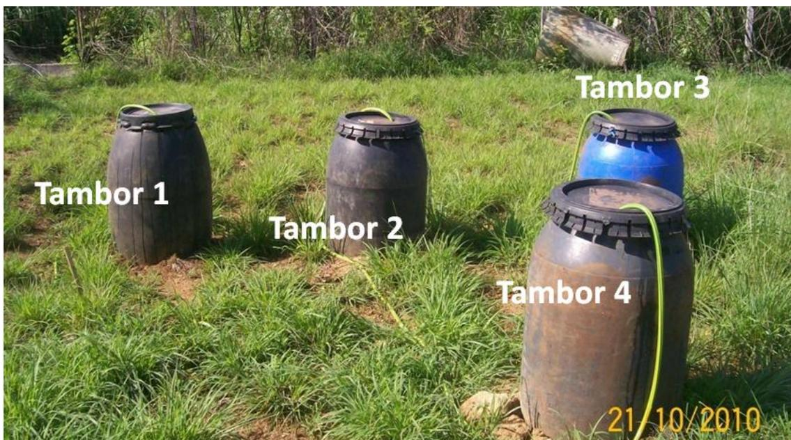
**Figura 13** Tambores utilizados na medição do esgoto drenado para cálculo da evapotranspiração.
