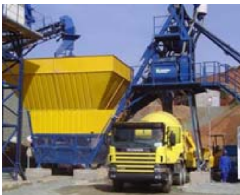
Ilustração 14 – Central Semi-móvel Misturadora (SCHWING STETTER, 2008)
