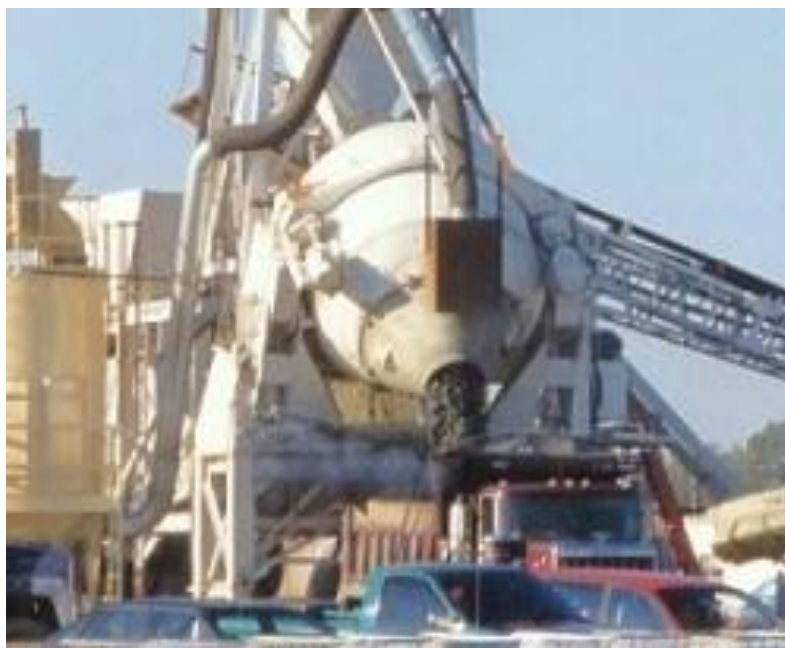
Ilustração 9 – Central Misturadora (PORTAL DO CONCRETO, 2008)
