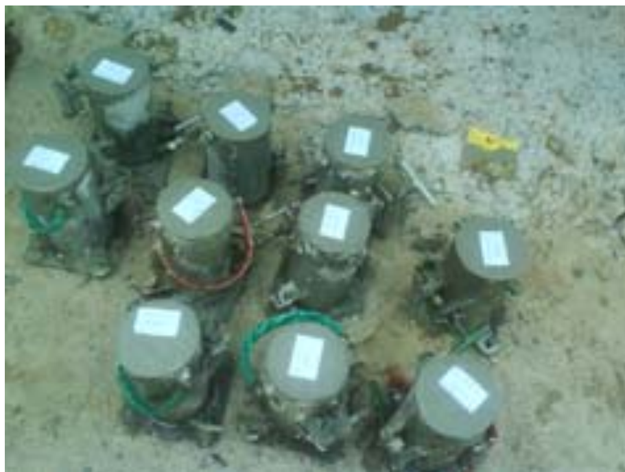
Ilustração 27 – Corpos de prova moldados na obra
