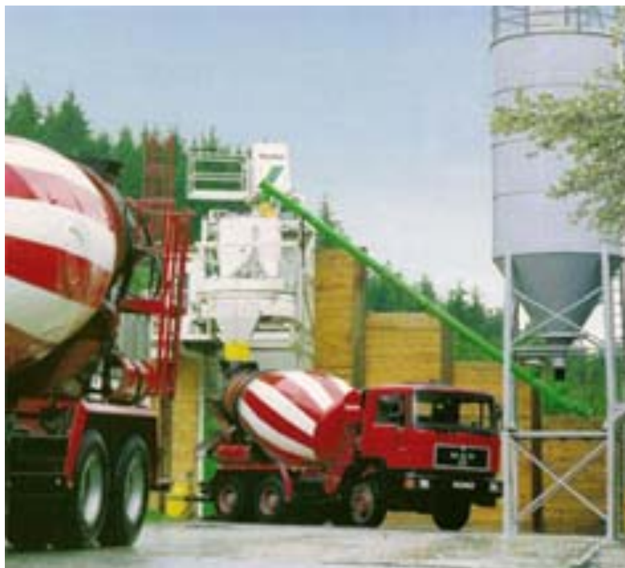
Ilustração 10 – Central Compacta Misturadora (SCHWING STETTER, 2008)
