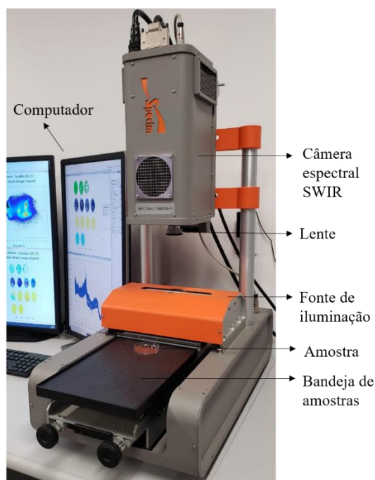
Figura 5. Estação de trabalho SisuCHEMA para aquisição de imagens SWIR. Fonte: Próprio autor.
