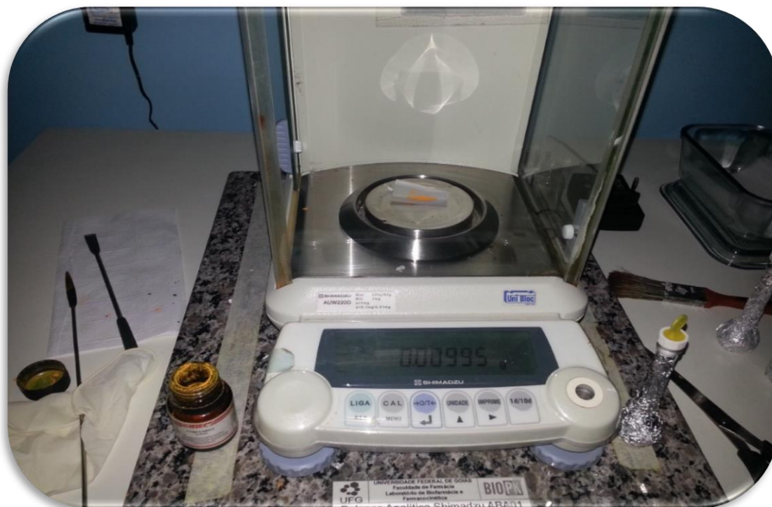
Imagem 1. Pesagem em balança analítica, do padrão VETEC- Curcumina
