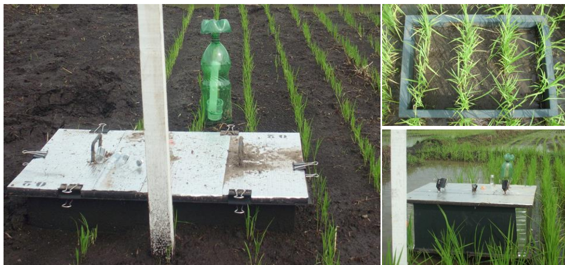
Figura 3. Câmaras de coleta de N-N 2 O (Mosier, 1989), instaladas na área experimental da Fazenda Palmital, Goianira-GO.
