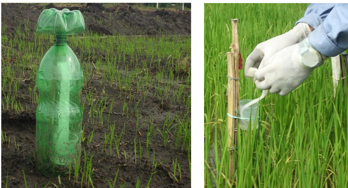
Figura 6. Câmaras coletoras do tipo SALE (câmaras semiaberta livre estática) de N-NH 3 , instaladas na área experimental da Fazenda Palmital, Goianira-GO.
