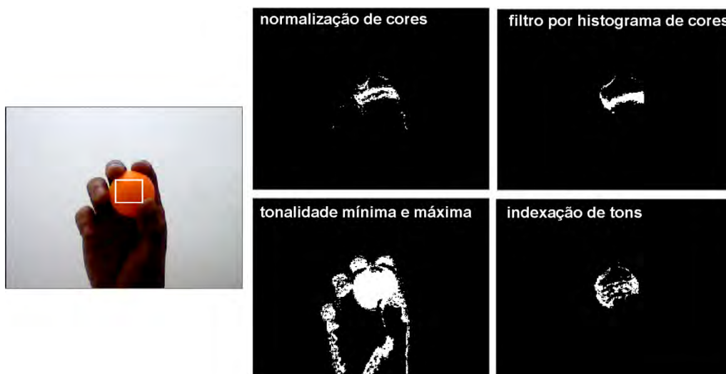
Figura 37 – Comparação entre métodos de segmentação utilizando um objeto de cor laranja durante o treinamento.
