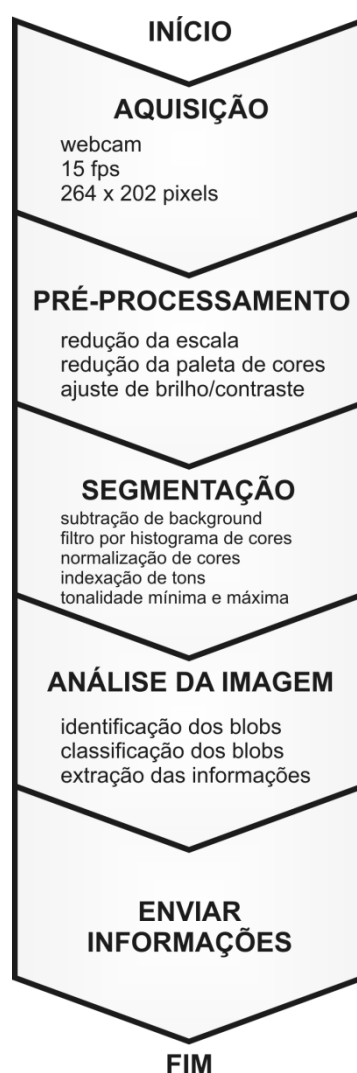
Figura 30 – Fluxograma do processamento realizado pela engine .
