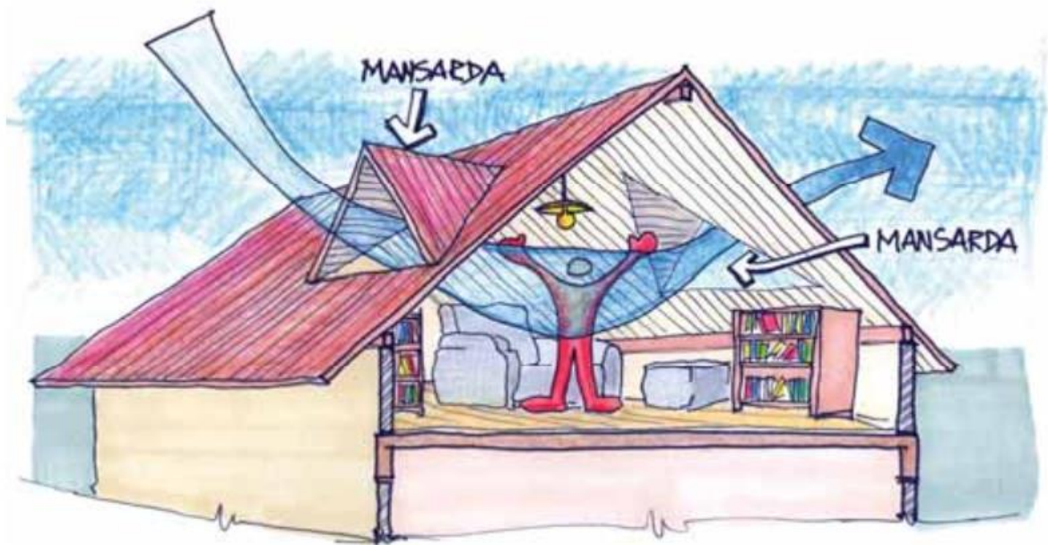
Figura 17 — Exemplificação de ventilação cruzada
