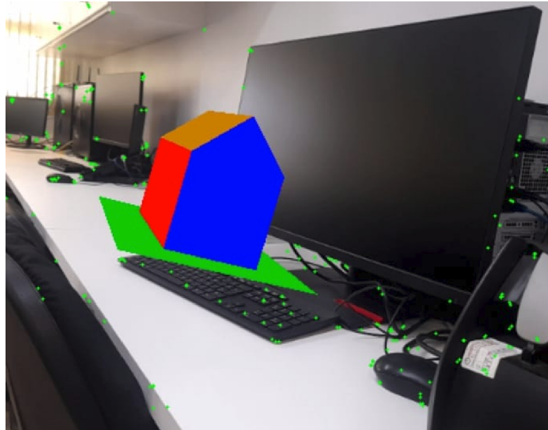
Figura 3.5: Imagem detalhada que mostra os pontos verdes da nuvem de pontos e o objeto tridimensional renderizado.
