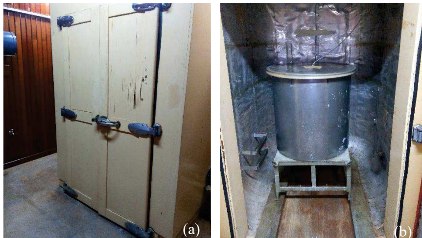
Figura 3.17 – (a) Vista geral da antessala. (b) Corpo de prova dentro do calorímetro
