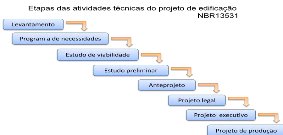
Figura 2.9- Etapas das atividades técnicas do projeto de edificação segundo a NBR 13531 (2000)
