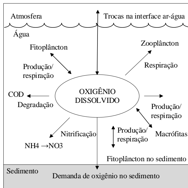
Figura 2 – Esquema dos principais mecanismos interagentes na dinâmica do oxigênio dissolvido na água e no sedimento. Adaptado de Fragoso Jr., Ferreira e Marques (2009).
