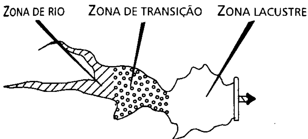
Figura 6 – Zonas de compartimentação de um reservatório
