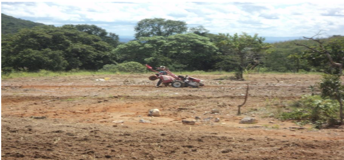
Figura 3.2. O preparo do terreno para plantio foi realizado com o Microtrator Tobata , equipado com enxada rotativa, fevereiro de 2012, Barro Alto, GO.
