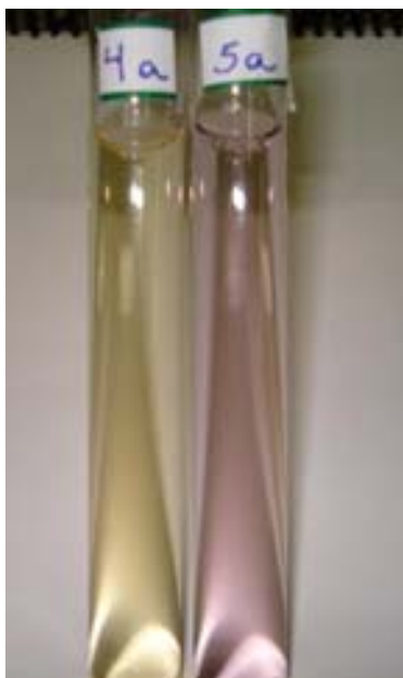
Figura 20. Comparação de cor entre os meios água com 0,5% de LSS (lado esquerdo) e HCl 0,1 mol/L (lado direito) ao final de 24h.
