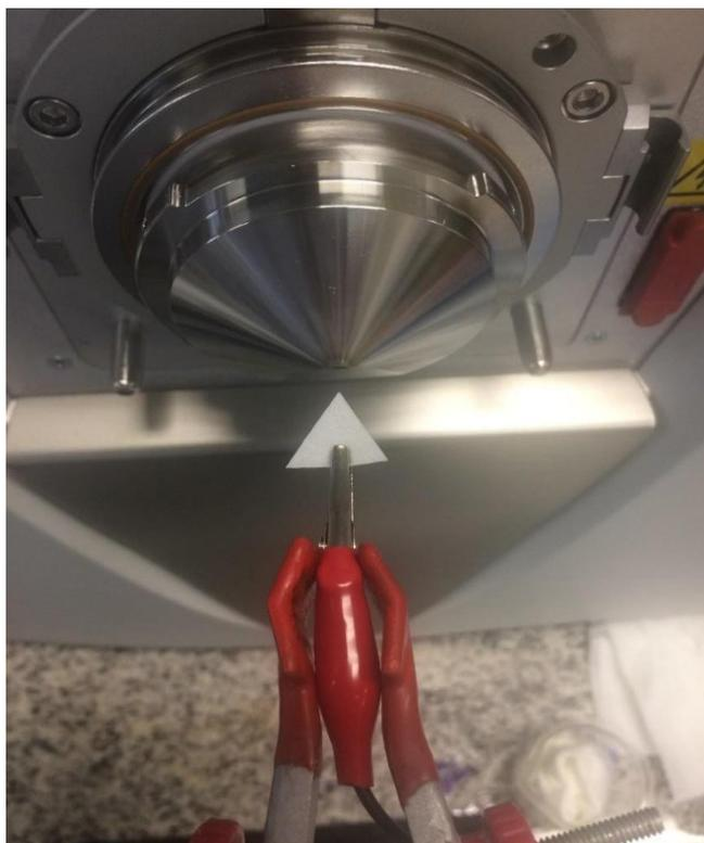
Figura 4: Foto ilustrativa do sistema homemade de de Paper Spray Ionization (PSI).
