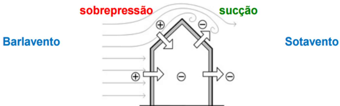
Figura 20 — Ações externas do vento em uma edificação
