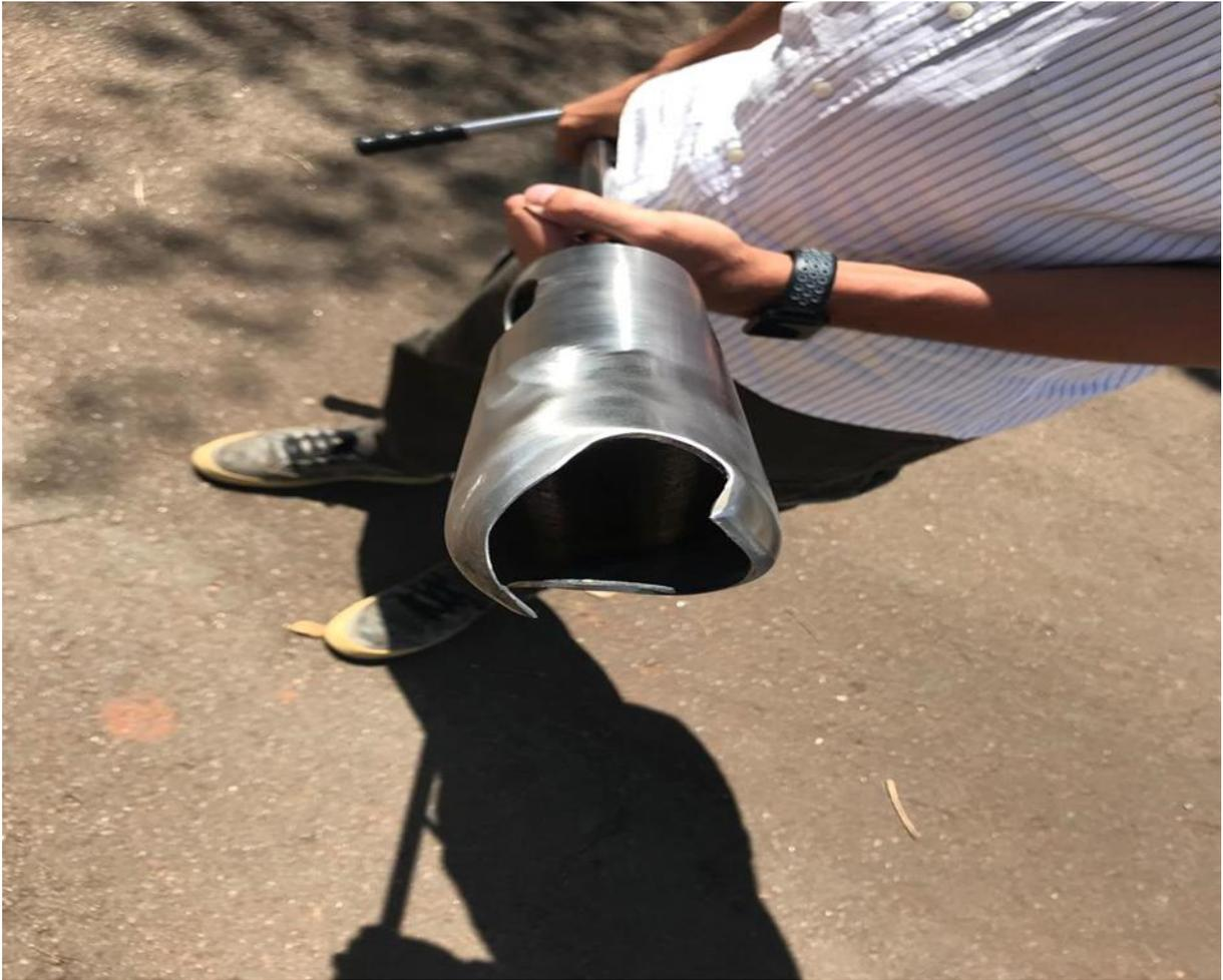
**Figura 11.** Trado holandês para abertura dos furos e instalação dos tubos de acrílico no solo.
