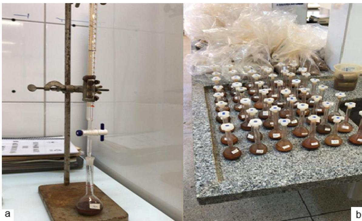
**Figura 8.** a) e b): Procedimentos de laboratório para determinação da densidade de partículas do solo.
