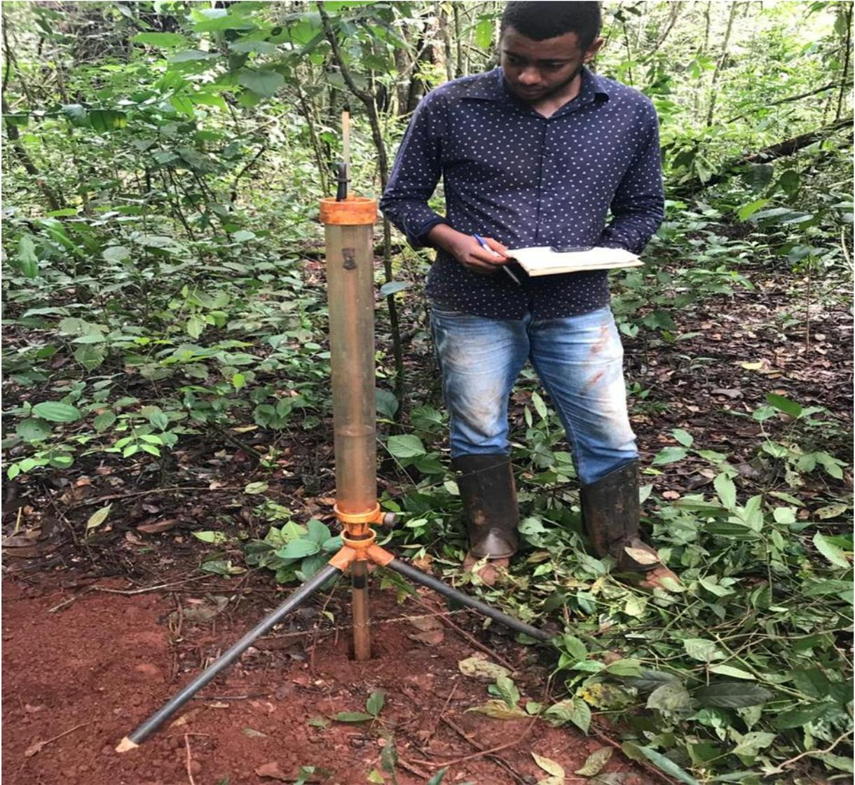
**Figura 6.** Coleta de dados através do permeômetro de Guelph no campo.
