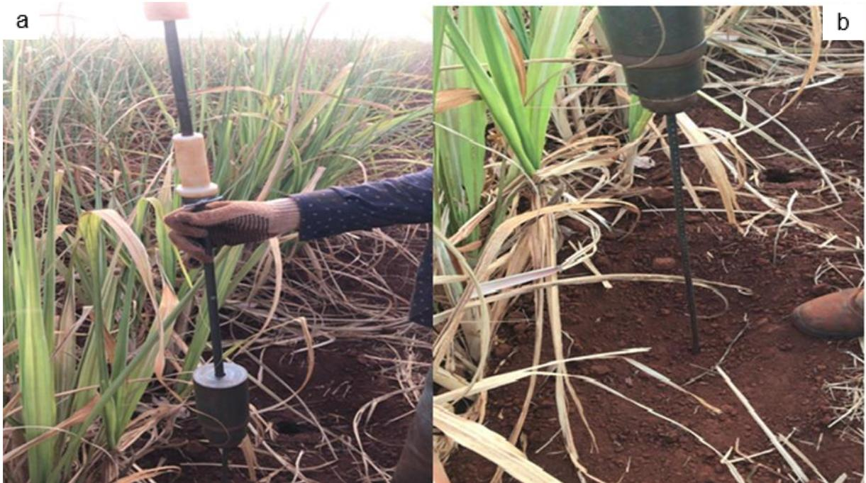
**Figura 5.** Leitura da resistência a penetração em campo. a) pesquisador manuseando penetrômetro. b) pesquisador realizando leitura da resistência à penetração em campo.
