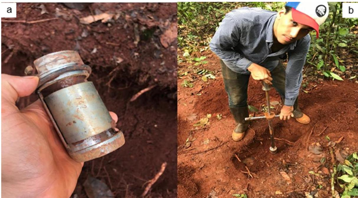
**Figura 3.** Coleta de anéis volumétricos em campo. a) anéis volumétricos após a coleta. b) pesquisador manuseando equipamento para realizar a coleta.
