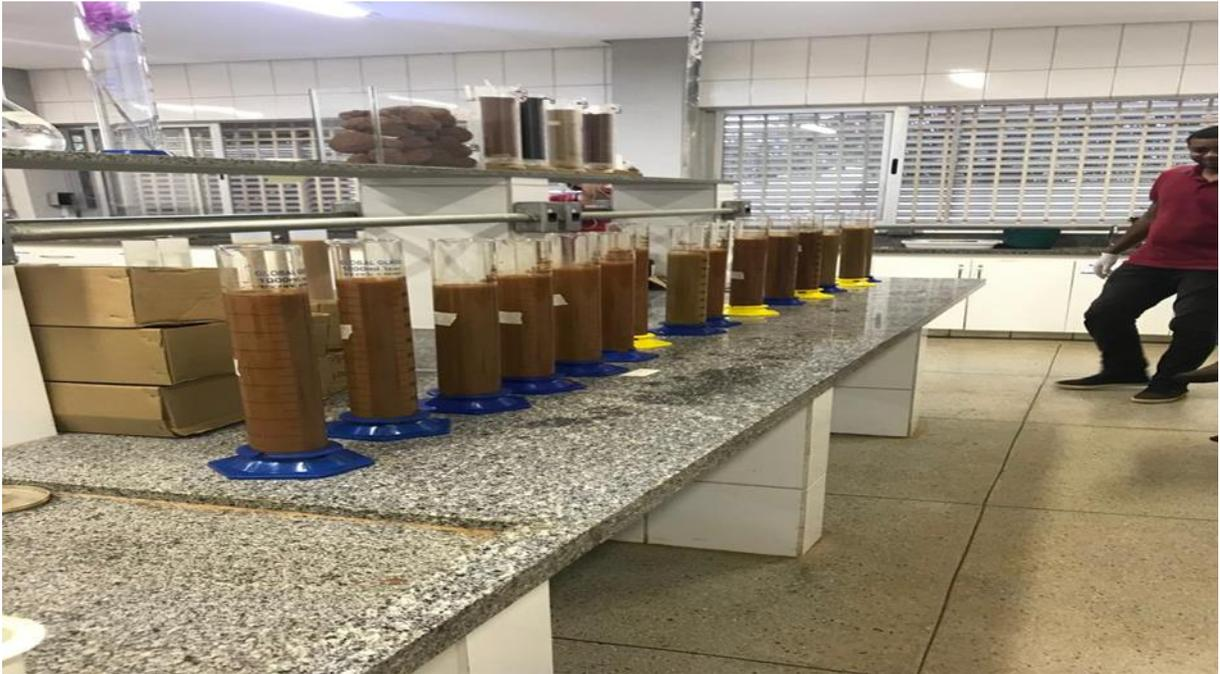
**Figura 7.** Procedimentos de laboratório para execução da análise granulométrica.
