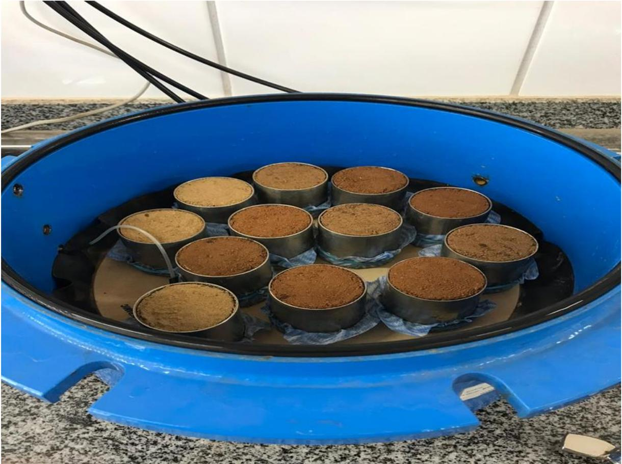
**Figura 10.** Câmara de Richards com amostras indeformadas.
