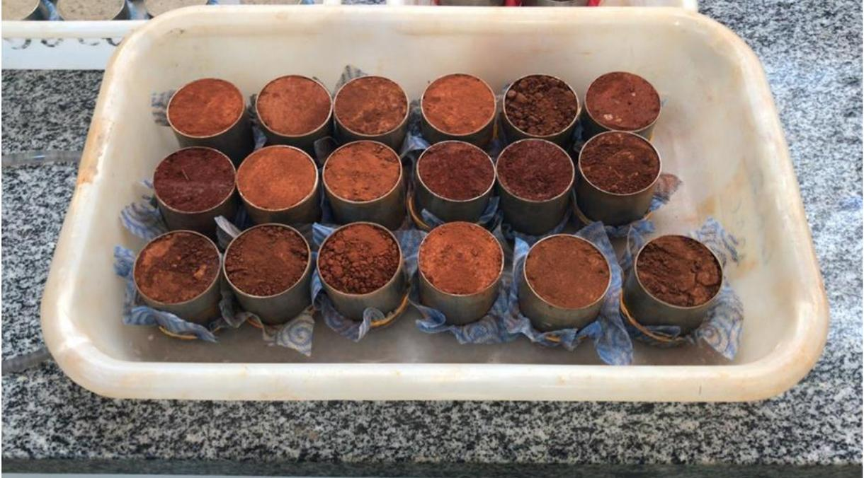
**Figura 9.** Amostras de solo em cilindro em processo de saturação.
