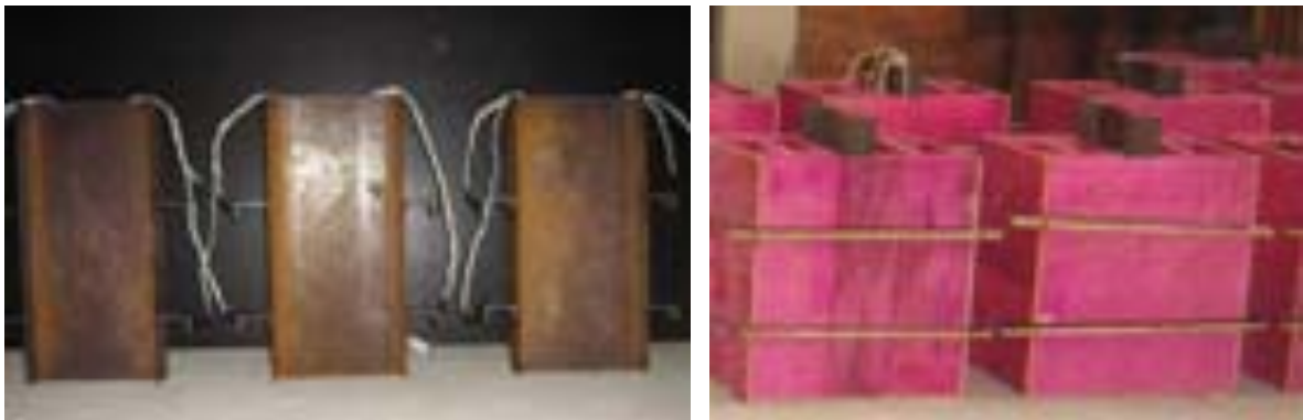
Figura 3.5 – Modelos confeccionados para o ensaio de cisalhamento direto
