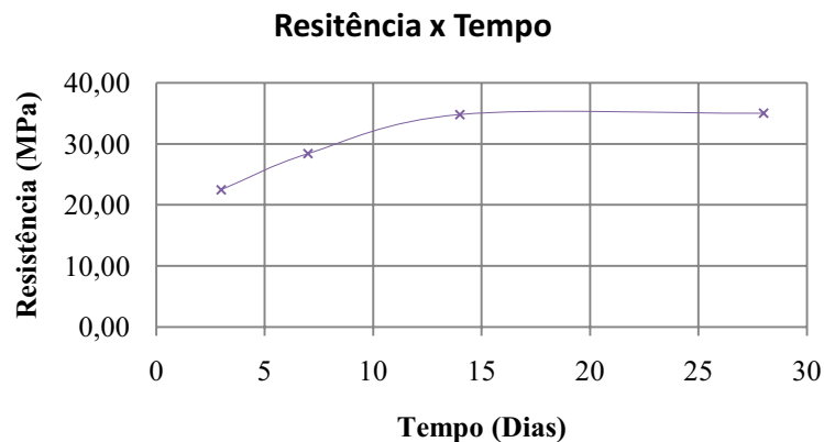
Figura 4.3 – Curva do ganho de resistência do concreto utilizado
