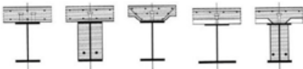
Figura 2.10 – Alguns tipos mais usuais de vigas mistas – EUROCODE 4:2001
