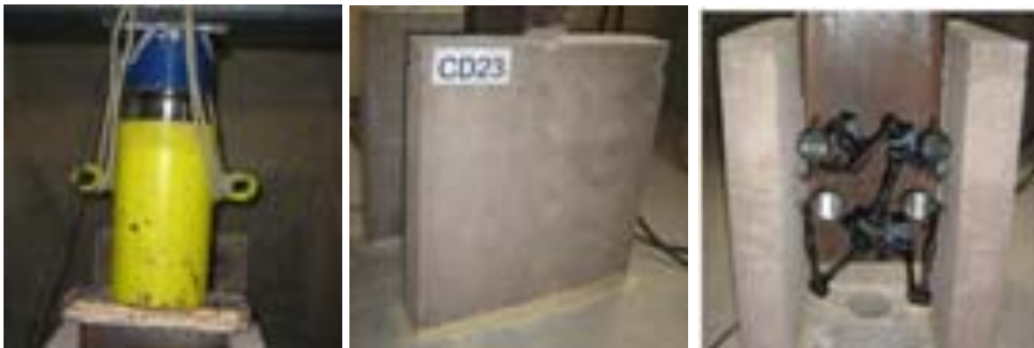
(a) Atuador hidráulico e célula de carga
