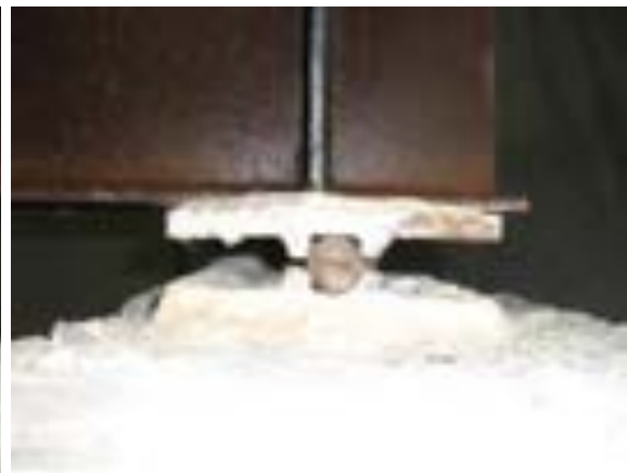
(a) aparelhos de apoio de primeiro e segundo gênero da viga ensaiada
