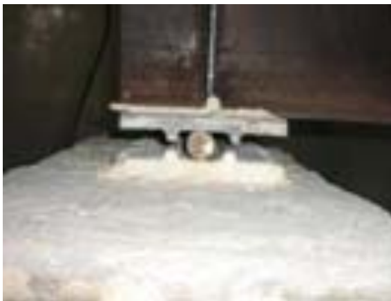
(a) aparelhos de apoio de primeiro e segundo gênero da viga ensaiada
