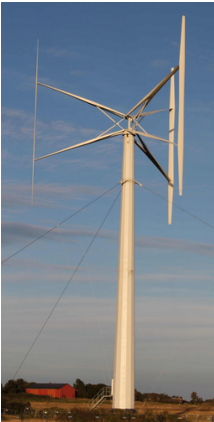
(a) A turbina eólica de três pás de eixo vertical na Suécia
