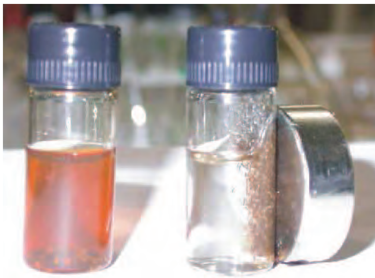
Figura 2.2 : A fotografia demonstra a sedimentação ocasionada pela presença do campo magnético.
