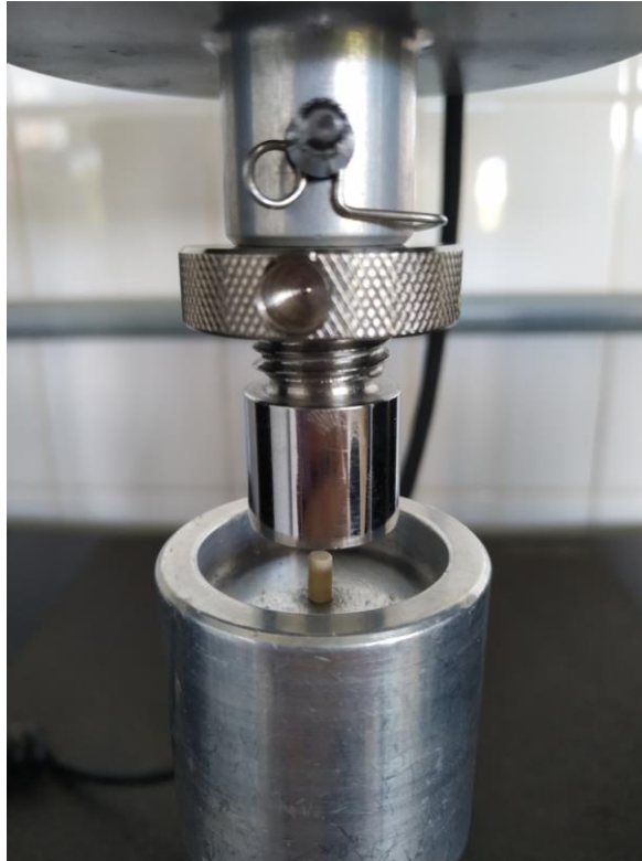
Figura 10 – Corpo de prova do cimento biocerâmico BIODENTINE® posicionado no centro do dispositivo do teste de resistência à compressão.
