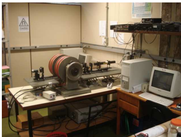
Figura 5.7 : Montagem experimental de BME do Laboratório de Magneto-óptica do IF-UFG.
