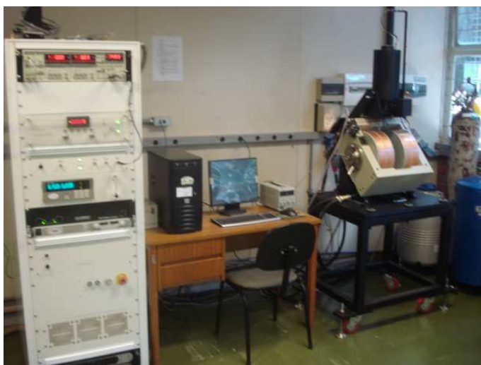
Figura 4.3 : Magnetômetro de amostra vibrante do laboratório de Magnetometria do Instituto de Física da UFG. Figura 2
