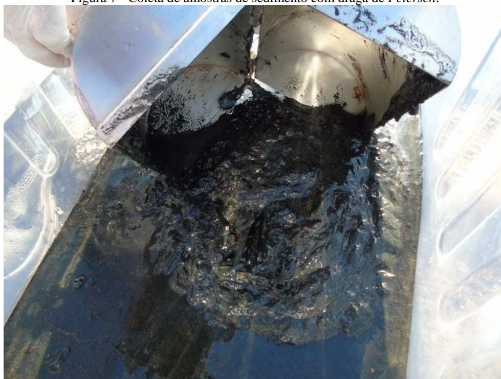
Figura 7 - Coleta de amostras de sedimento com draga de Petersen .
