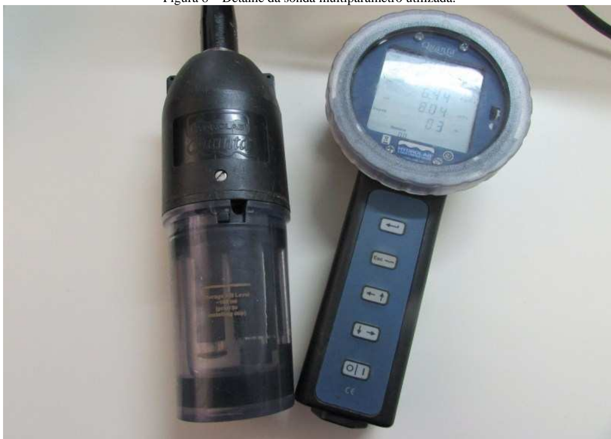
Figura 8 – Detalhe da sonda multiparâmetro utilizada.
