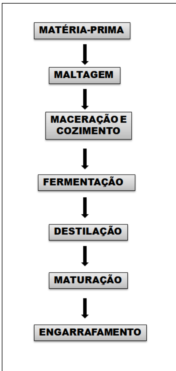
Figura 14: Fluxograma com as etapas do processo de fabricação do uísque.
