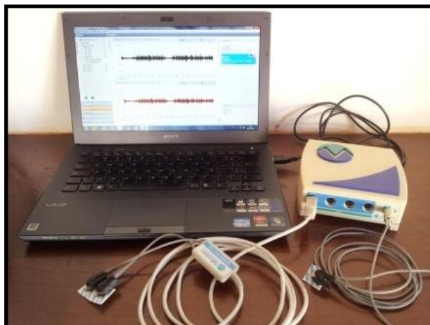
Figura 4 – Eletromiógrafo MIOTOOL 200 da marca MIOTEC®
