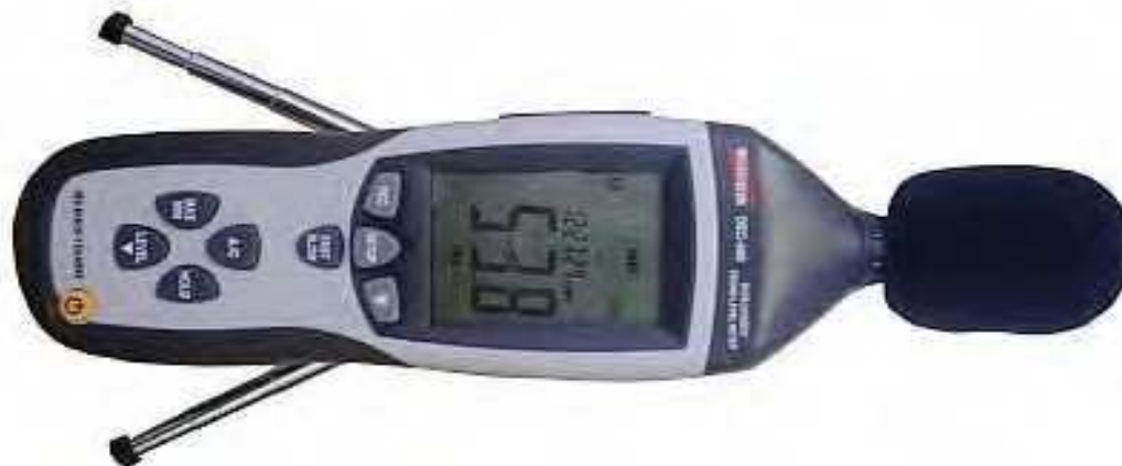
Figura 2 – Decibelímetro - DEC-420 usado na medição de NPS
