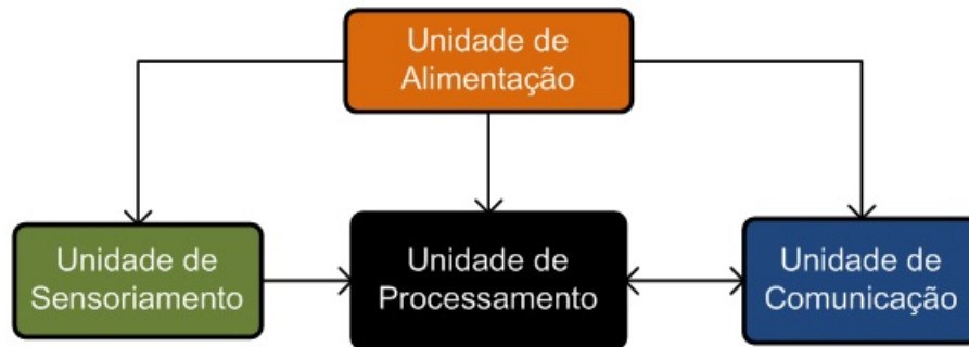
Figura 5.7: Arquitetura de hardware do nó sensor 2.0.
