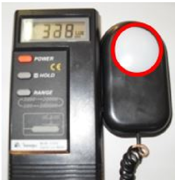
Figura 3.24: Delimitação da região fotossensível do Luxímetro.
