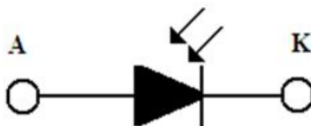
Figura 3.13: Símbolo esquemático do fotodiodo.
