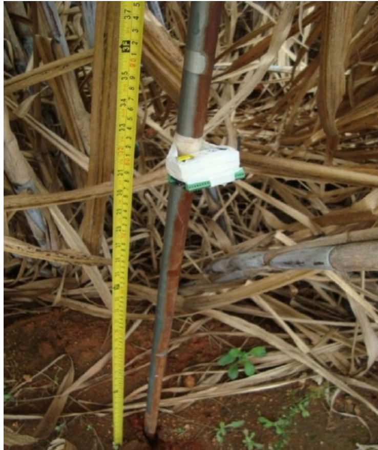
Figura 2.14: Mote IRIS com placa de sensoriamento e altura 0.8m aplicado em plantação de cana-de-açúcar - Fazenda Itaiquara, 2011. Fonte: [27]
