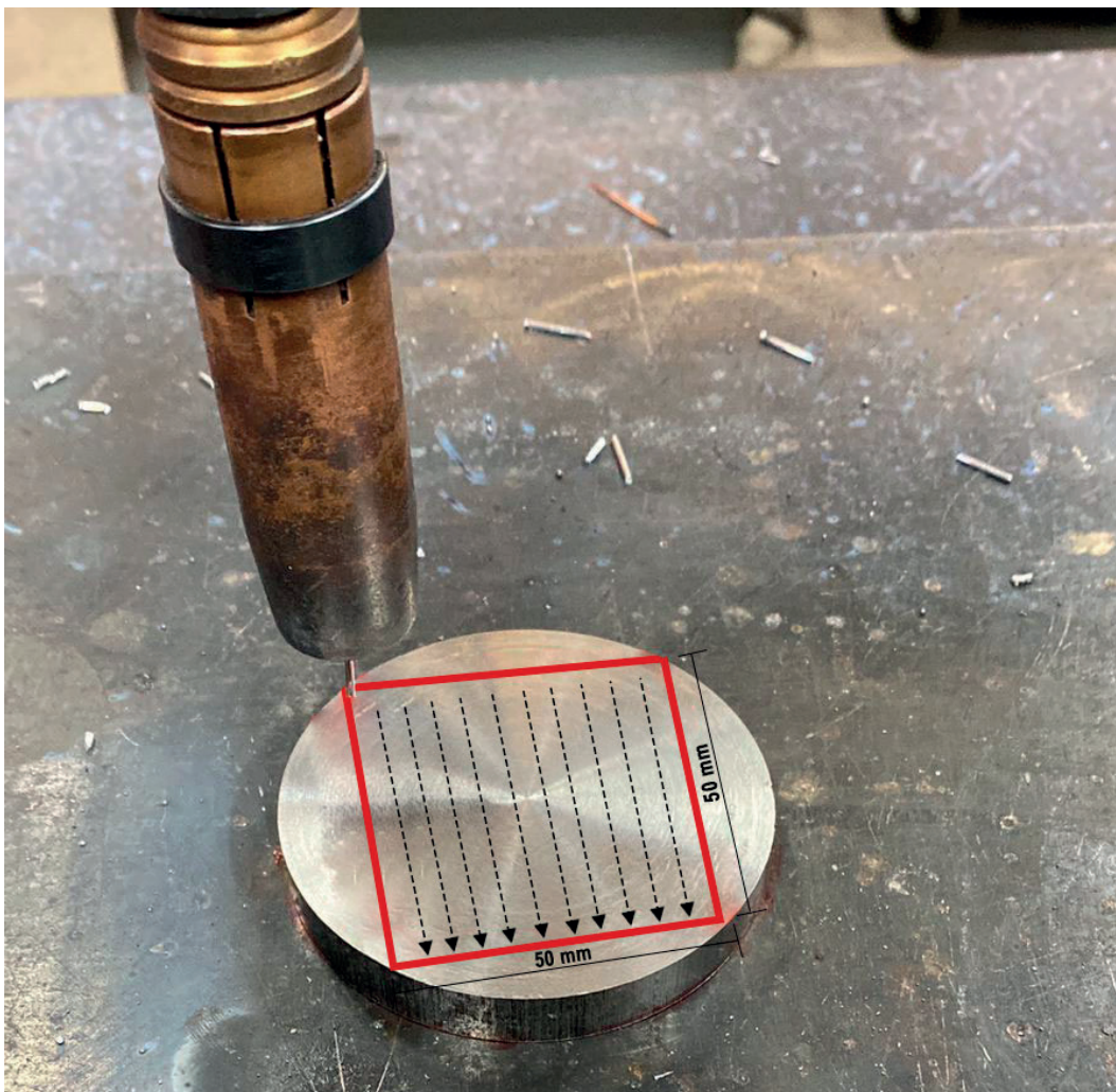
Figura 52: Pontos traçados para aplicar o revestimento.
