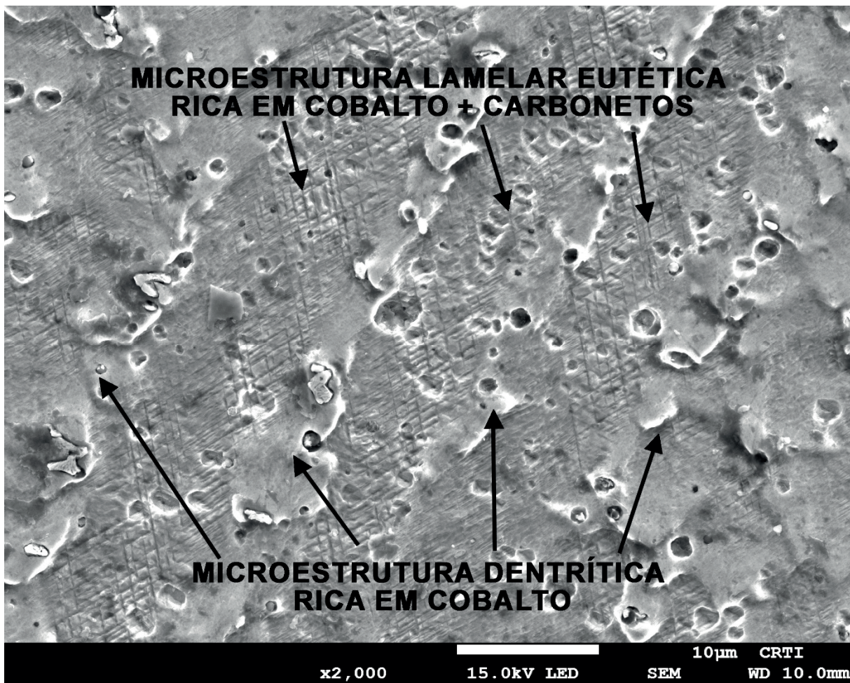
Figura 76: MEV da ampliação da região de revestimento da liga de cobalto composta pela região dendrítica e interdendrítica.
