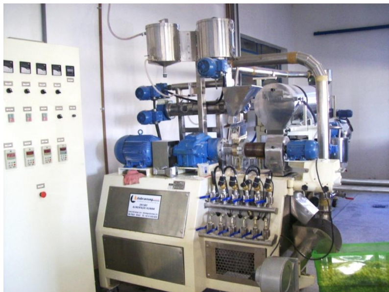
Figura 5. Extrusora (Imbramaq, PQ30, Ribeirão Preto, Brasil), utilizada na extrusão das farinhas pré-gelatinizadas de fécula e bagaço de mandioca
