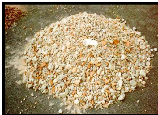
Figura 2.17 – Aspecto do agregado graúdo reciclado (ZORDAN, 1997).
