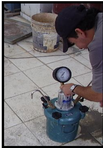
Figura 4.18 – Ensaio no concreto fresco: teor de ar incorporado.
