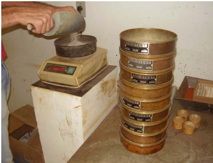
Figura 4.6 – Peneiras utilizadas no ensaio da determinação da composição granulométrica.
