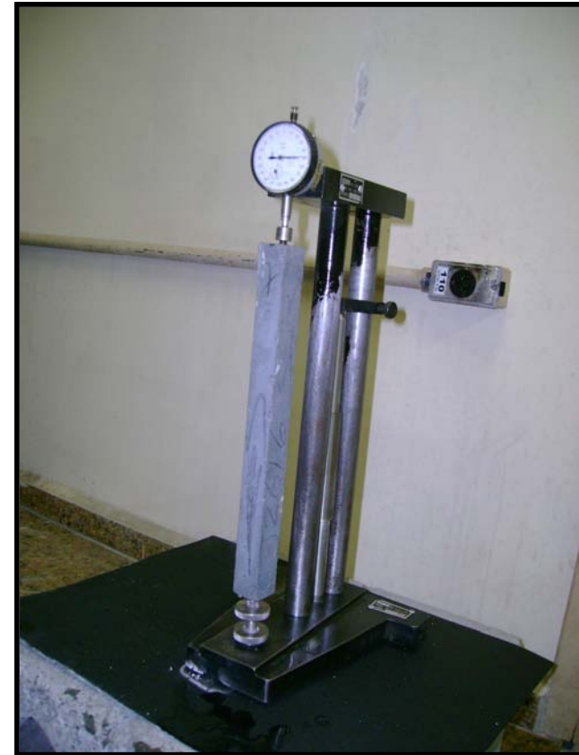
Figura 4.24 – Amostra prismática em ensaio de aferição de expansão por RAA. ASTM C-1260 (ASTM, 2001).
