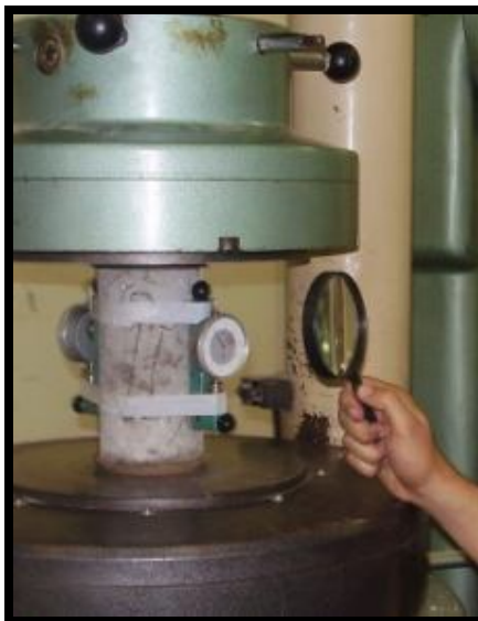
Figura 4.23 – Ensaio de módulo de deformação, utilizando medidor mecânico de deformação.
