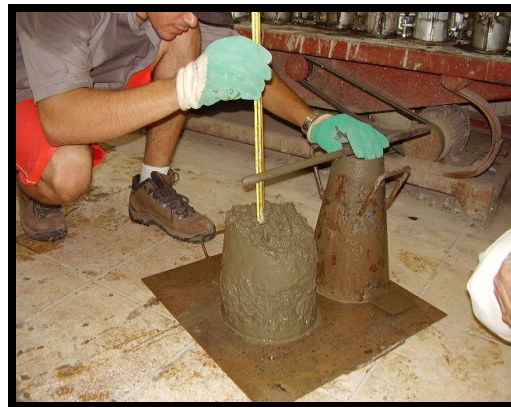
Figura 4.17 – Ensaio no concreto fresco: abatimento do tronco de cone.
