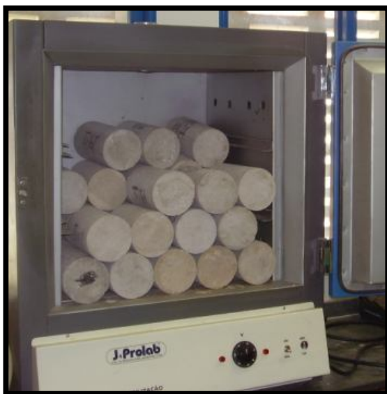
Figura 4.25 – Ensaio de absorção sendo realizado – CPs na estufa.
