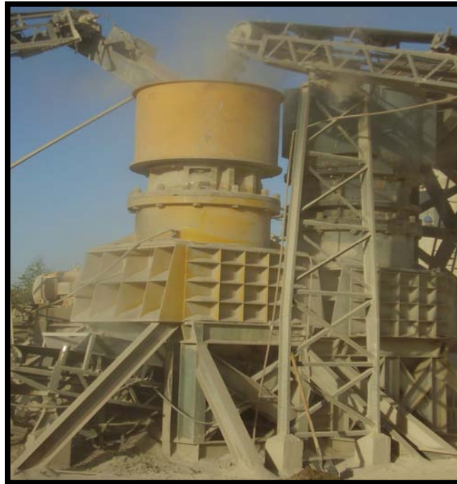
Figura 2.9 – Britador em processo de produção – Britador de eixo vertical
