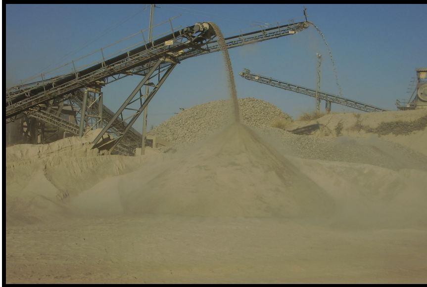
Figura 2.14 – Pilha de areia de brita produzida por via seca.
