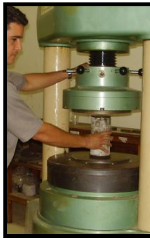
Figura 4.20 – Ensaio de resistência à compressão sendo preparado.
