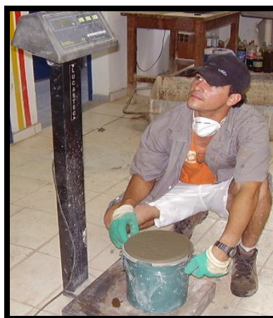
Figura 4.19 – Ensaio no concreto fresco: massa específica.
