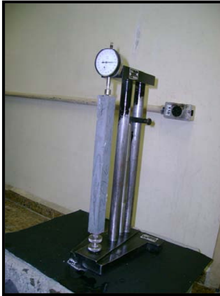
Figura 4.24 – Amostra prismática em ensaio de aferição de expansão por RAA.
