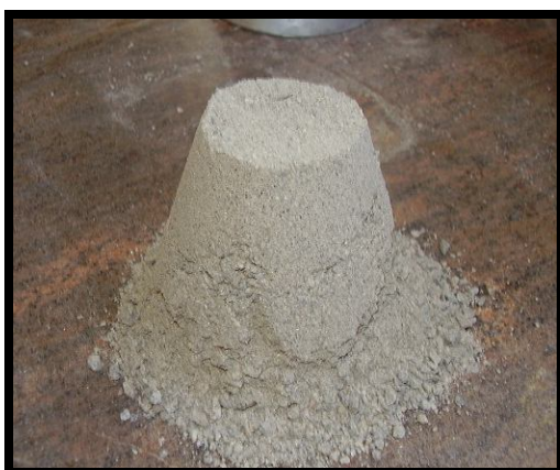
Figura 4.10 – Cone de agregado saturado.
