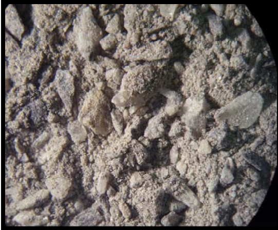
Figura 5.5 – Imagem ampliada dos grãos da areia de britagem.
