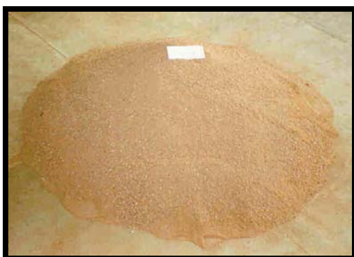
Figura 2.16 - Aspecto do agregado miúdo reciclado (ZORDAN, 1997).
