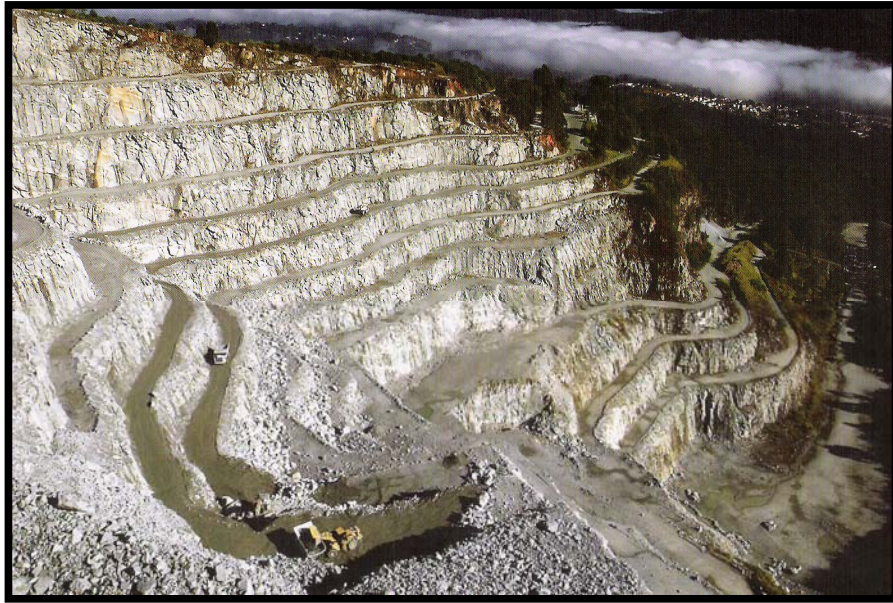
Figura 2.10 – Bancada para extração de agregados (HOLCIM, 2007).
