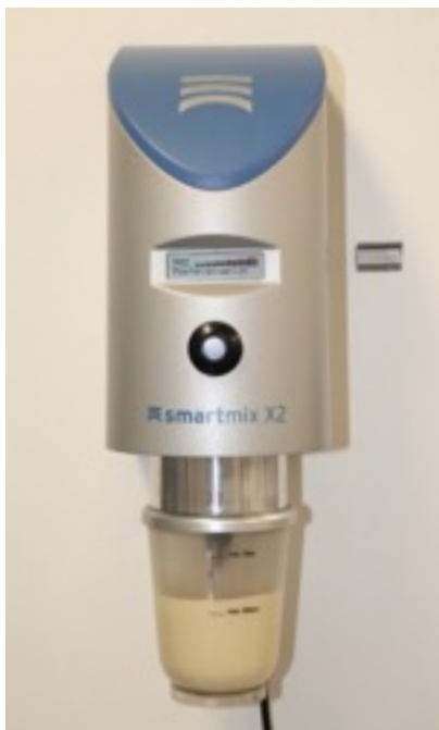
Figura 1. Espatulador à vacuo- Smartmix X2; Figura 2. Vibrador odontológico Vibra 20- Tecnodent; Figura 3. Gesso pedra tipo IV- FujiRock. Fonte: Próprio autor.
