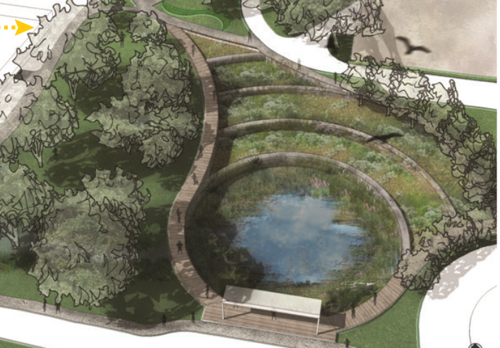
Figura 5D: Bacia de detenção integrada ao paisagismo.
