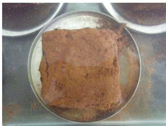
Figura 4.36 – Trincas ocorridas no topo do CP LG-5
