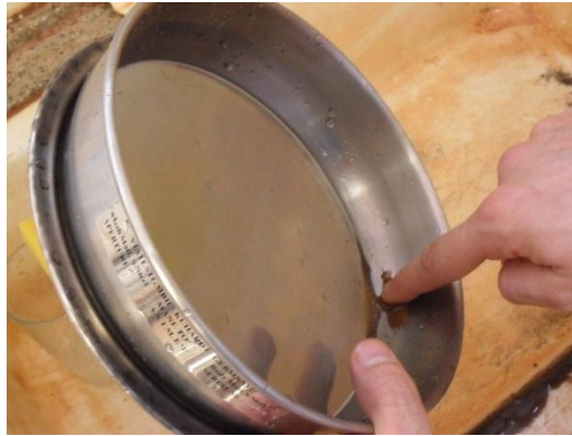
Figura 3.15 – Lavagem dos agregados
