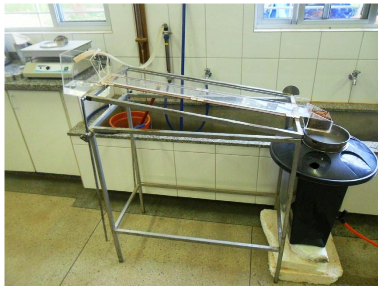
Figura 3.11 – Equipamento de Inderbitzen
