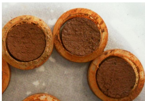
Figura 4.4 – Amostra de Latossolo com elevada contração diametral
