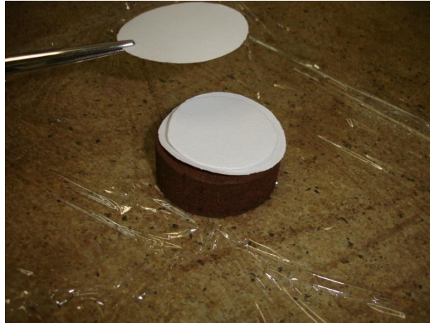
Figura 3.6 – Utilização do Papel Filtro na obtenção da sucção matricial
