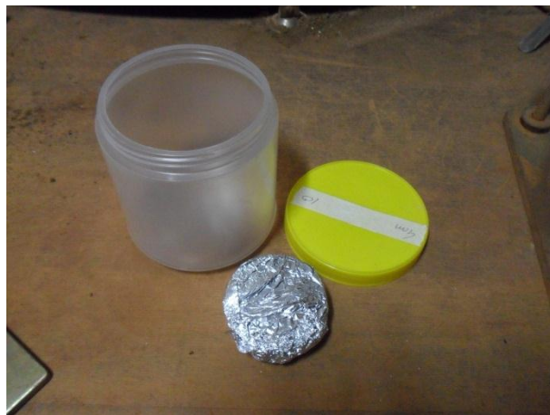
Figura 3.7 – Procedimento para atingir o equilíbrio entre o corpo-de-prova e o papel filtro
