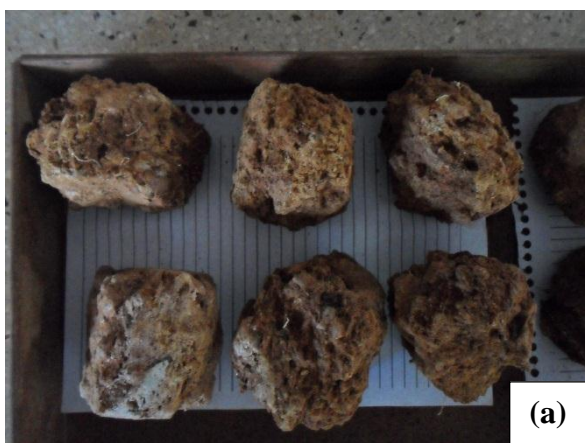
Figura 3.16 – Modelos dos corpos de prova: (a) amostra de Cambissolo em formato amorfo; (b) amostra de Latossolo, em formato cúbico
