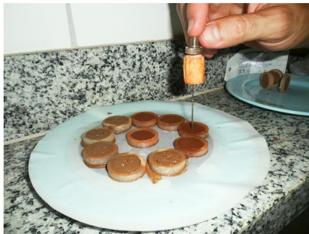
Figura 2.9 – Anéis de PVC e penetrômetro manual utilizados no ensaio de pastilha
