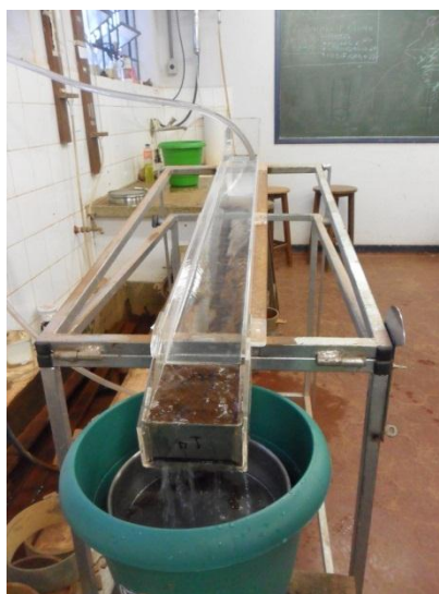
Figura 3.14 – Peneira nº 200 (0,075 mm) adaptada ao final do equipamento
