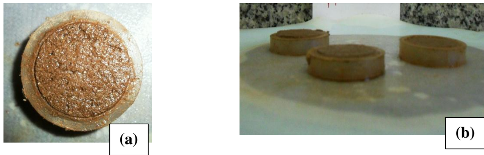
Figura 4.2 – Amostra de Cambissolo: (a) com pequenas trincas, aspecto rugoso; (b) com baixo processo expansivo
