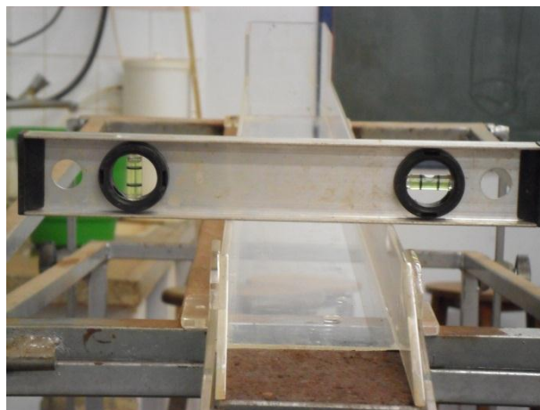
Figura 3.13 – Nivelamento do aparelho de Inderbitzen
